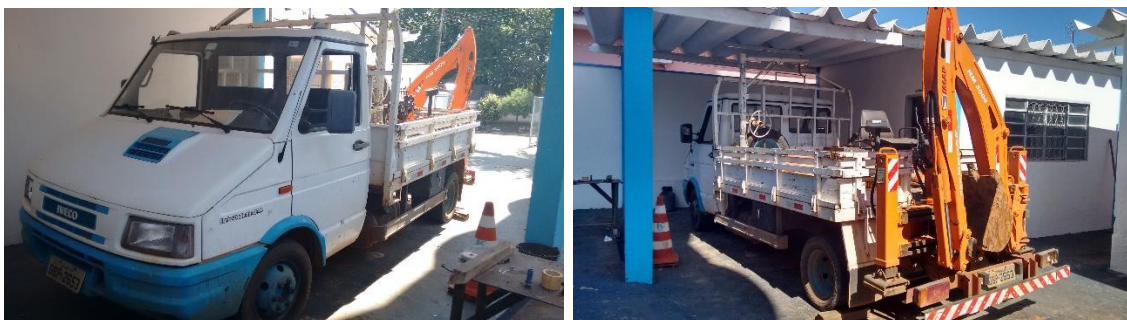
Imagem 9.2: Caminhão \frac{3}{4} com valetadeira para os serviços de saneamento em Catiguá.
