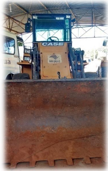
Imagem 8.10: Pá carregadeira utilizada na cobertura da vala do Aterro.
