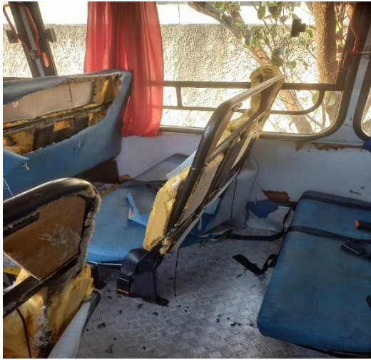
-Ônibus DKI-3206: bancos rasgados e cintos de segurança em mau estado de conservação.
